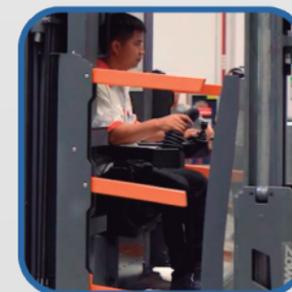
Seguridad y estabilidad con dos puertas de rejilla electrónicamente bloqueadas en la cabina para prevenir accidentes.
